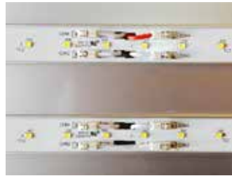
Moduli LED sostituibili
